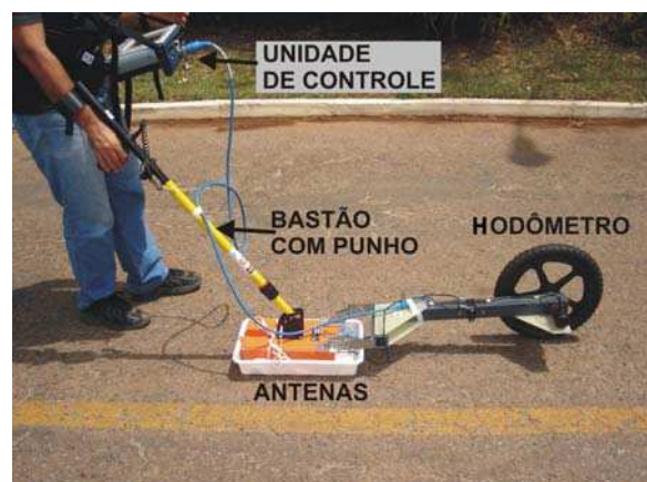
Figura 6.16 - Equipamento GPR utilizado no experimento
