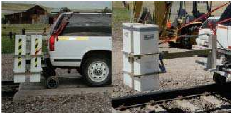
Figura 6.6 - Antenas GPR montadas em uma estrutura adaptada a um veículo que percorre a via férrea Fonte: Olhoeft e Selig (2002)
