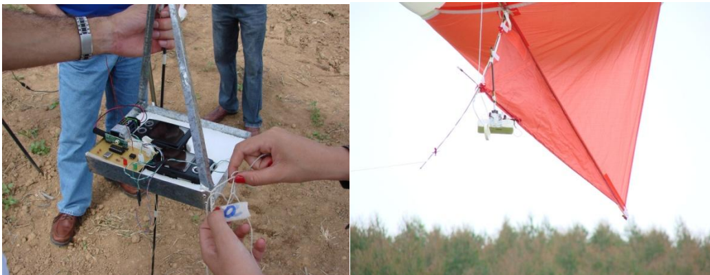
Figura 11 - Plataforma contendo as câmeras digitais e o acoplamento no balão.
