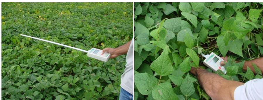
Figura 8 - Utilização do ceptômetro para medir a área foliar.
