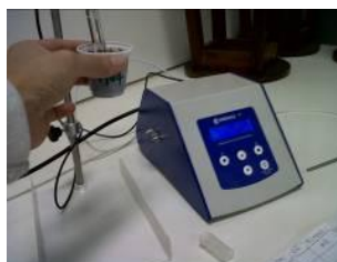
Figura 3: Determinação de pH através de pHmetro.
