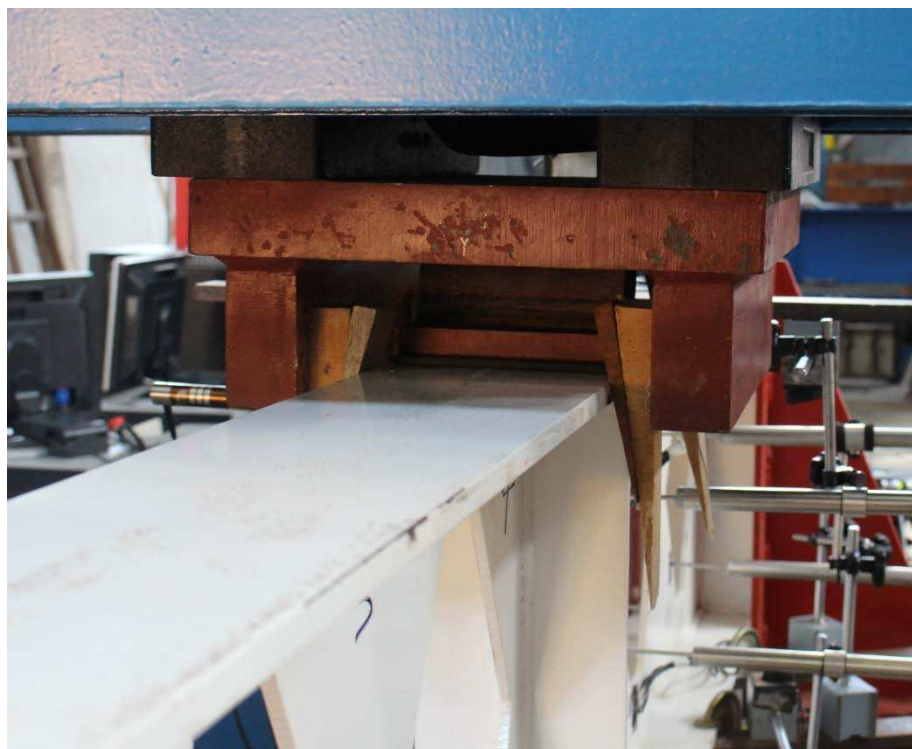
Figura 32 – Aparato utilizado no ponto de aplicação do carregamento.
