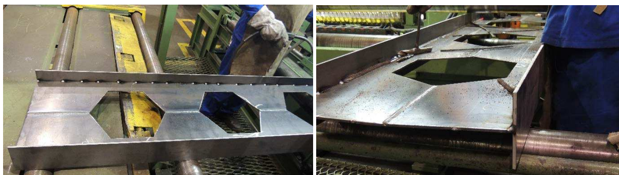
Figura 21 – Aspecto geral da fabricação da viga castelada, com a soldagem da alma às mesas. (a) Montagem preliminar com soldas ponteadas; (b) Viga alveolar com solda contínua.
