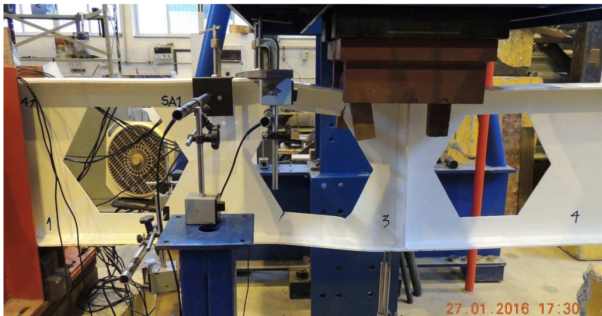
Figura 53 – Aspecto da viga SA1 ao final do ensaio.
