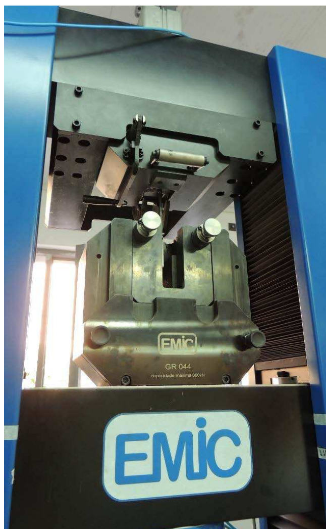
Figura 27 – Máquina universal de ensaios EMIC DL60000.
