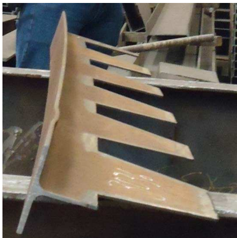
Figura 14 – Empenamento da metade de um perfil laminado, após o corte.
