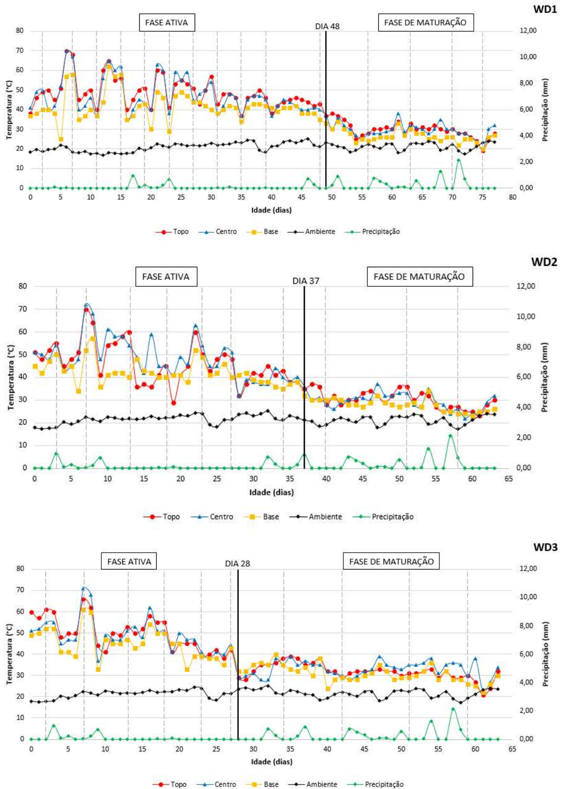
FIGURA 16 – PERFIL DA MÉDIAS DAS TEMPERATURAS RELATADAS NAS LEIRAS REVIRADAS – MÉTODO WINDROW.
