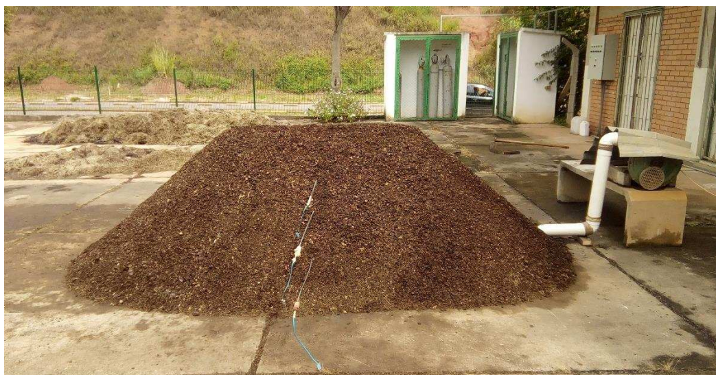
FIGURA 3 – LEIRA ESTÁTICA MONTADA SOBRE TUBO DE AERAÇÃO, COBERTA COM CAMADA DE COMPOSTO MATURADO E COM A DISPOSIÇÃO DAS SONDAS DE TEMPERATURA.
