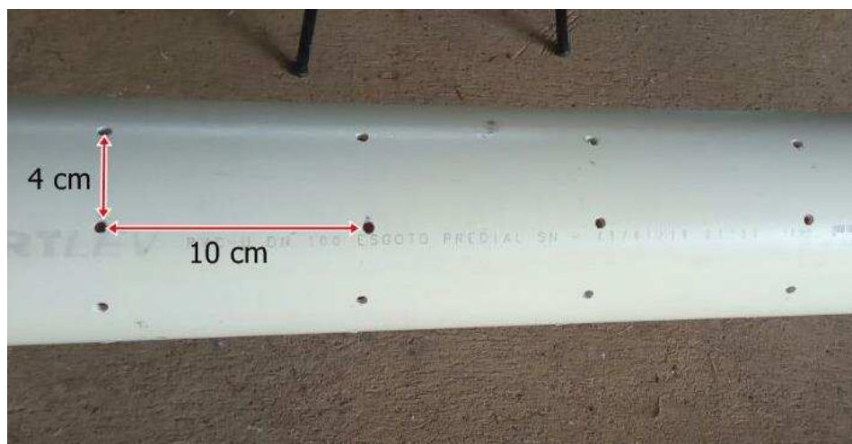
FIGURA 1 – DISPOSIÇÃO DOS FUROS NA TUBULAÇÃO DE AERAÇÃO.
