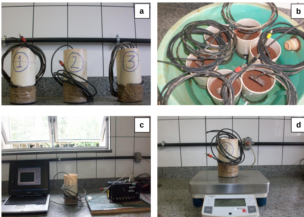
Figura 15. Fotografias ilustrando o processo de calibração de guias de onda da TDR; a – guias de ondas inseridas verticalmente nas colunas de solo; b – colunas de solo em saturação; c – leituras da constante dielétrica; d – determinação do teor de água das colunas por gravimetria.
