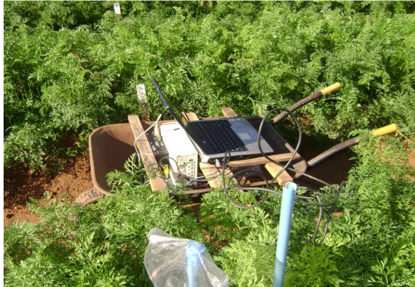
Figura 18. Leituras do teor de água no solo utilizando a técnica da reflectometria no domínio do tempo (TDR).
