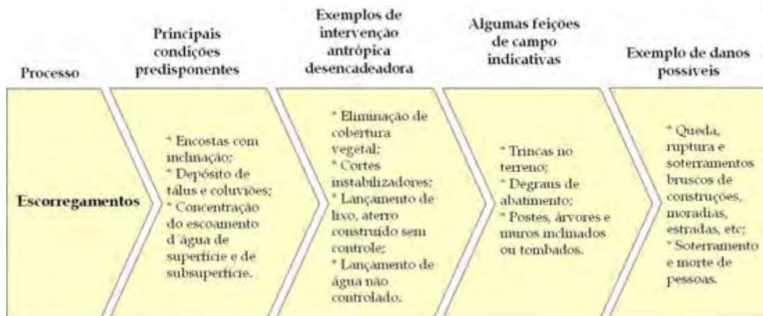
Figura 2.6 – Processo geológico de escorregamento.
