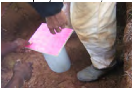
Cravação do amostrador.
