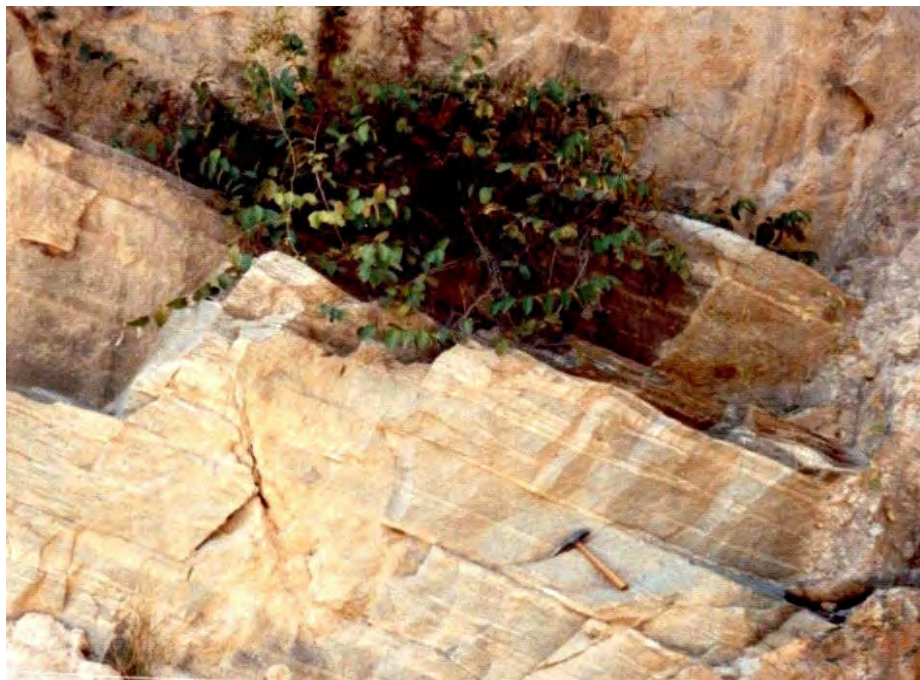
b – Gnaisse do Complexo Belo Horizonte. Fraturas pouco resistentes e foliação bem marcada. Fonte: Adaptado de Costa (2002).
