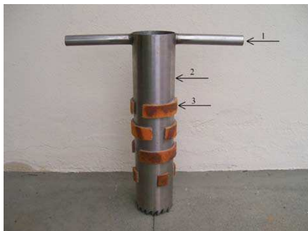
Figura 6 - Parte móvel do amostrador, em detalhes: 1 – tubo de acionamento em aço inox de 32 mm de diâmetro e 0,20 m de comprimento; 2 – segmento de tubo de aço inox de 120 mm de diâmetro e 0,60 m de comprimento; e 3 – segmento de anel de PVC revestido de flanela objetivando melhor ajuste e deslizamento no tubo guia.
