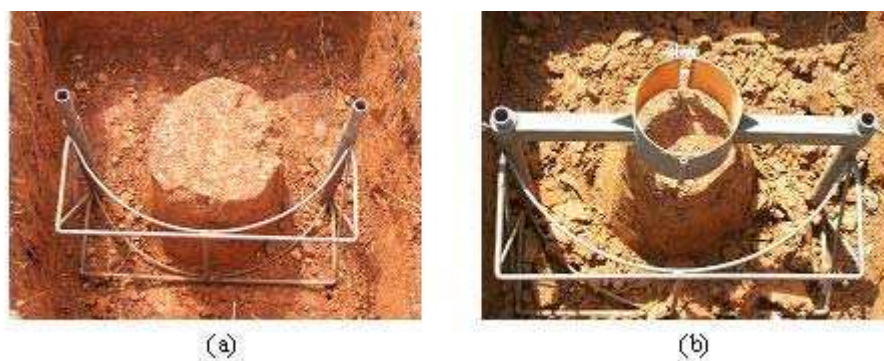
Figura 16 - Instalação do amostrador em campo: a) cravamento do suporte de fixação e dos tubos de aço galvanizado no solo; b) fixação braçadeira nos tubos de aço galvanizado.
