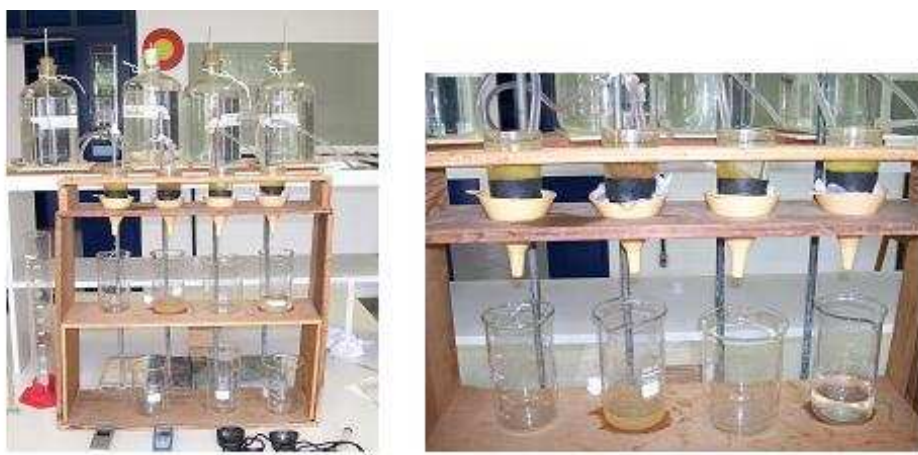
Figura 12 - Permeômetros montados para determinação da condutividade hidráulica.
