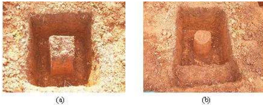
Figura 15 - a) Escavação realizada com o monólito ao centro; b) coluna de solo após uma preparação prévia, com um diâmetro ligeiramente superior ao do elemento cortante do amostrador.
