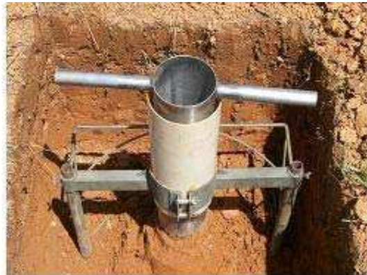
Figura 17 - Parte móvel encaixada tubo guia do amostrador, em operação, durante a retirada da amostra.
