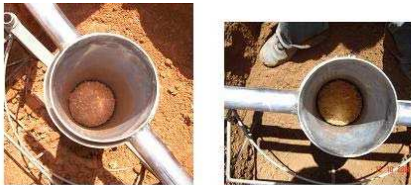
Figura 18 - Ilustração do espaço deixado entre a amostra e parede interna do tubo de inox.
