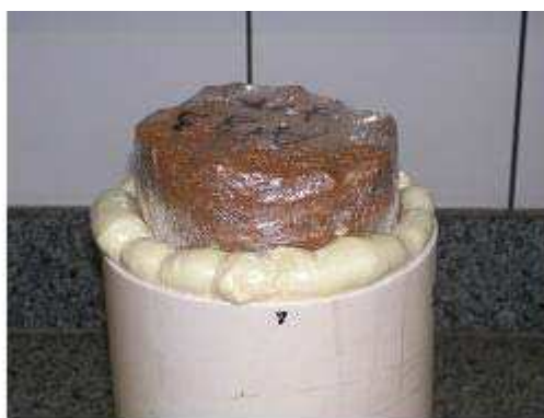
Figura 10 - Coluna de solo com a espuma de poliuretano após 24 horas de aplicação.
