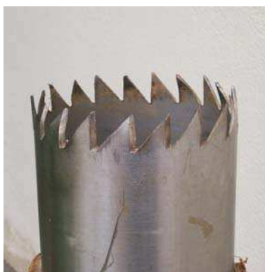
Figura 7 – Detalhe da extremidade denteada do tubo.
