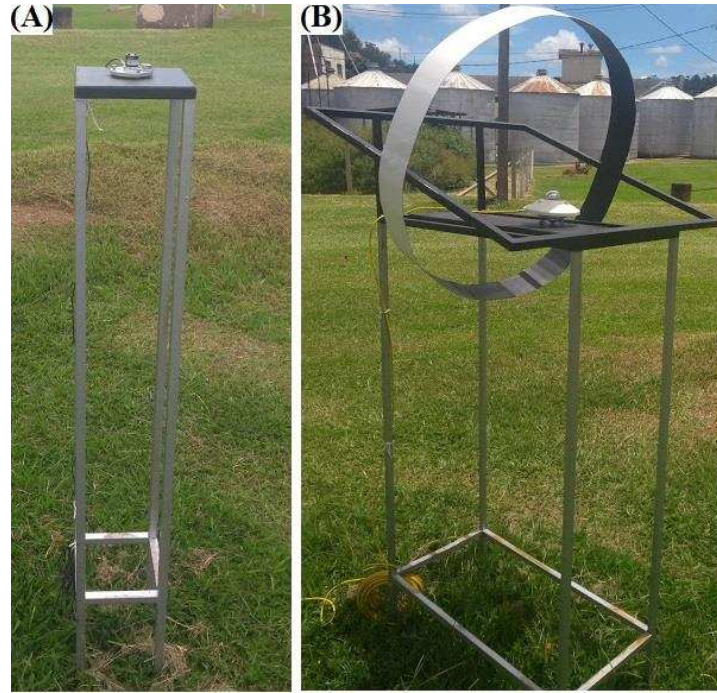
Figura 13. Medição da radiação solar: (A) global e (B) difusa.
