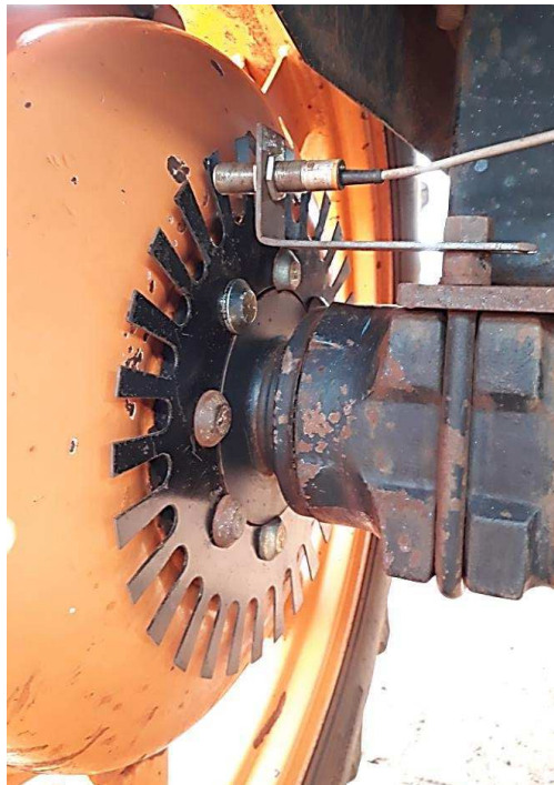
Figura 10. Sensor indutivo utilizado para determinação da patinagem dos rodados motrizes do Transformax.
