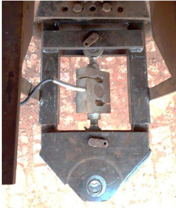
Figura 8. Célula de carga e estrutura suporte para instalação no trator
