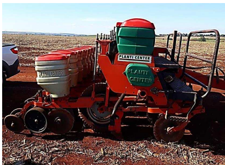
Figura 5. Semeadora-adubadora, vista lateral.
