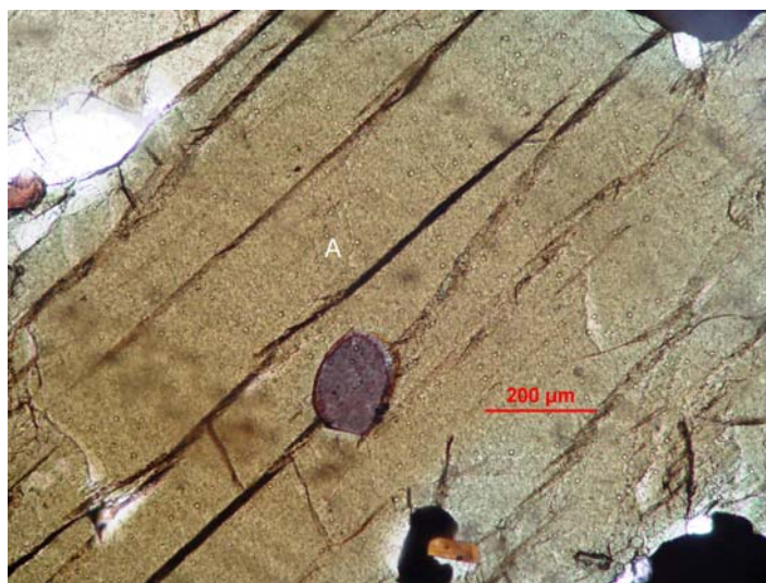
Figura 45 - Nicóis paralelos. Traços da clivagem na superfície do anfibólio (A) bem delineados por material de preenchimento (possivelmente óxido de ferro precipitado).
