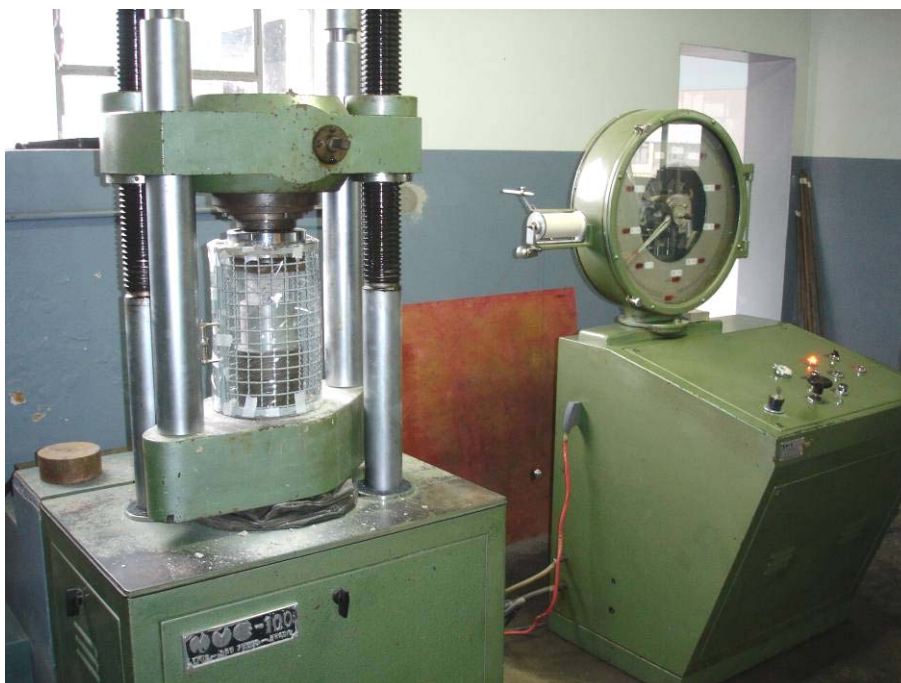
Figura 16 – Equipamento utilizado para o ensaio de compressão uniaxial, com uma capacidade de carregamento de até 100 toneladas.
