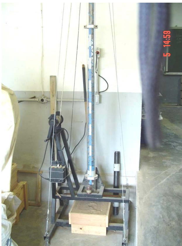
Figura 15 – Equipamento utilizado para o ensaio de impacto de corpo duro.
