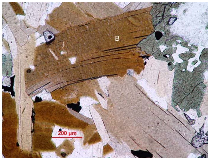
Figura 46 - Nicóis paralelos. Aspecto semelhante ao da Figura 67 verificado para os traços da clivagem na superfície das biotitas (B).
