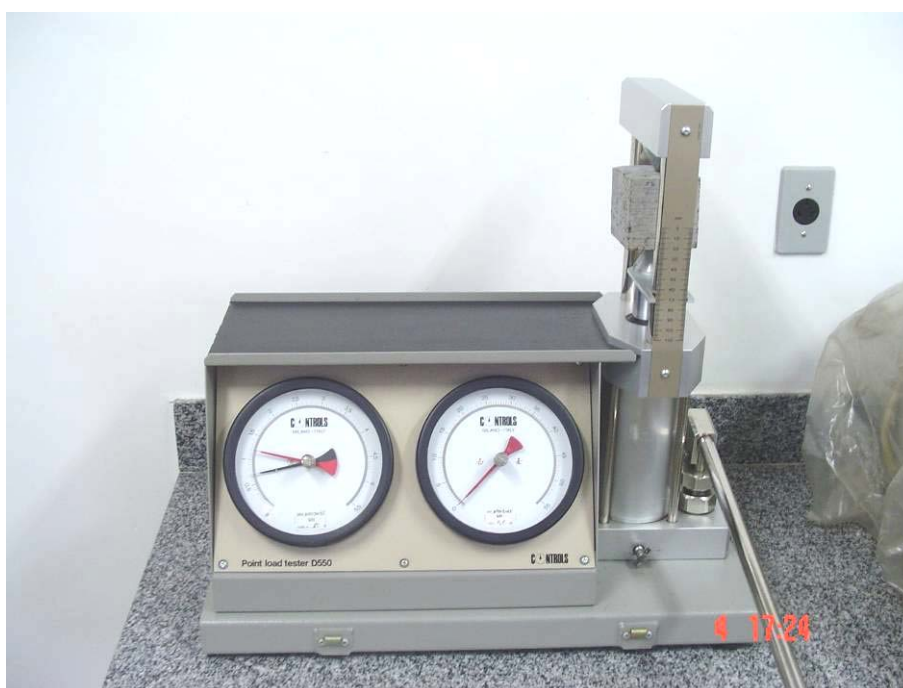
Figura 18 – Equipamento utilizado para o ensaio de resistência à compressão puntiforme.
