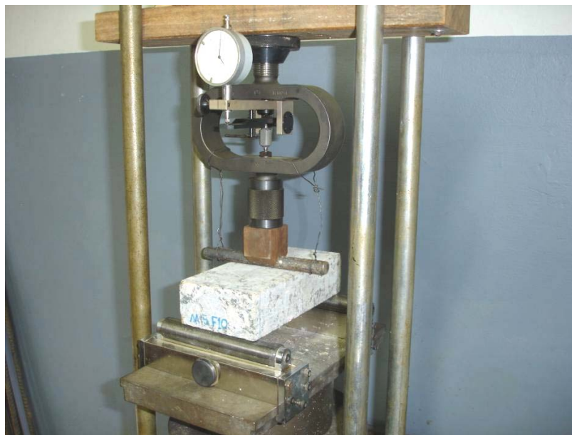
Figura 14 – Equipamento utilizado para o ensaio de flexão.
