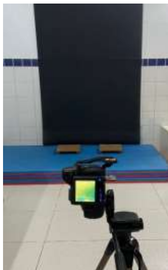
Figura 1: Ambiente de coleta dos termogramas.
