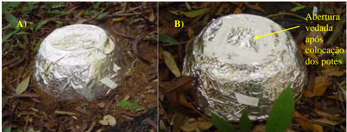
Figura 6. Campânulas instaladas no campo. A) campânula sobre solo ou saco, enterrada 3 cm no solo. B) campânula vedada por baixo com abertura na parte superior para colocação dos potes com NaOH constituindo o branco.
