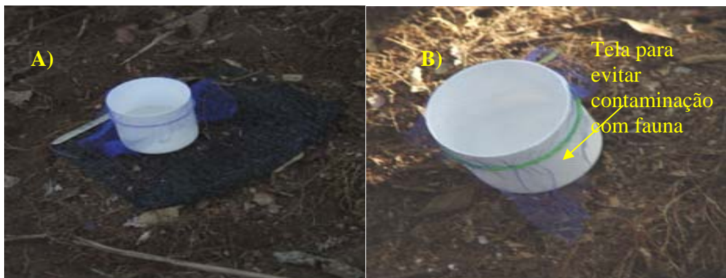
Figura 8. Potes com NaOH para captura de \text{CO}_2 . A) pote sobre unidade experimental para avaliar respiração das folhas. B) pote diretamente sobre o solo da mata para avaliar respiração do mesmo (matéria orgânica deste).
