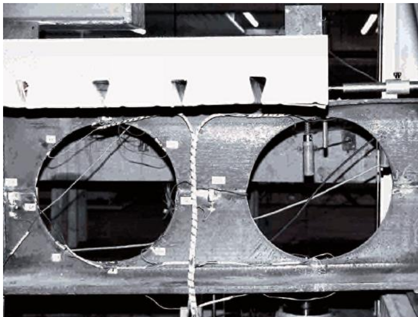
Figura 37 – Formação de mecanismo Vierendeel na abertura 11 do modelo experimental RWTH-B3 (MÜLLER et al. , 2006).
