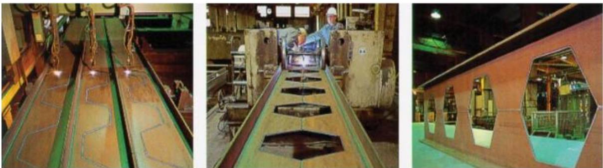
Figura 5 - Fabricação de um perfil alveolar (adaptado de GEMPERLE, 2007 apud GONÇALVES, 2015).
