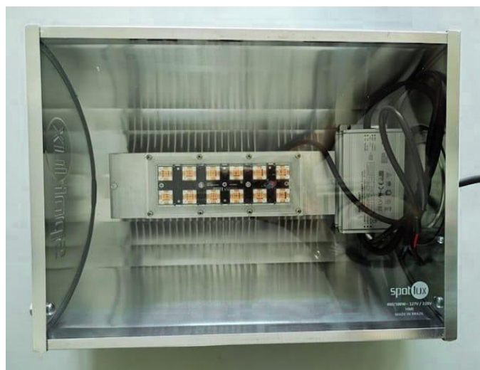
Figura 1: Disposição da lâmpada de LED e seu respectivo driver no refletor, utilizados para a suplementação luminosa em plantas de milho. Fonte: Patricia Carvalho, 2021.
