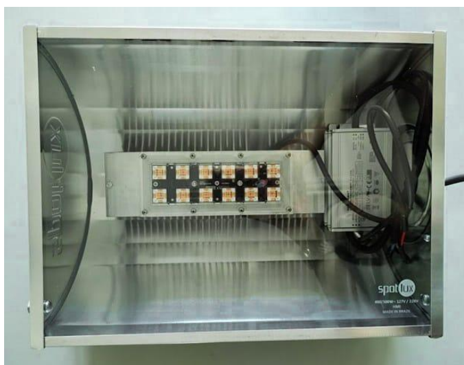
Figura 1: Disposição da lâmpada de LED e seu respectivo driver no refletor, utilizados para a suplementação luminosa em plantas de milho ( Zea mays ). Fonte: Patricia Carvalho, 2021.
