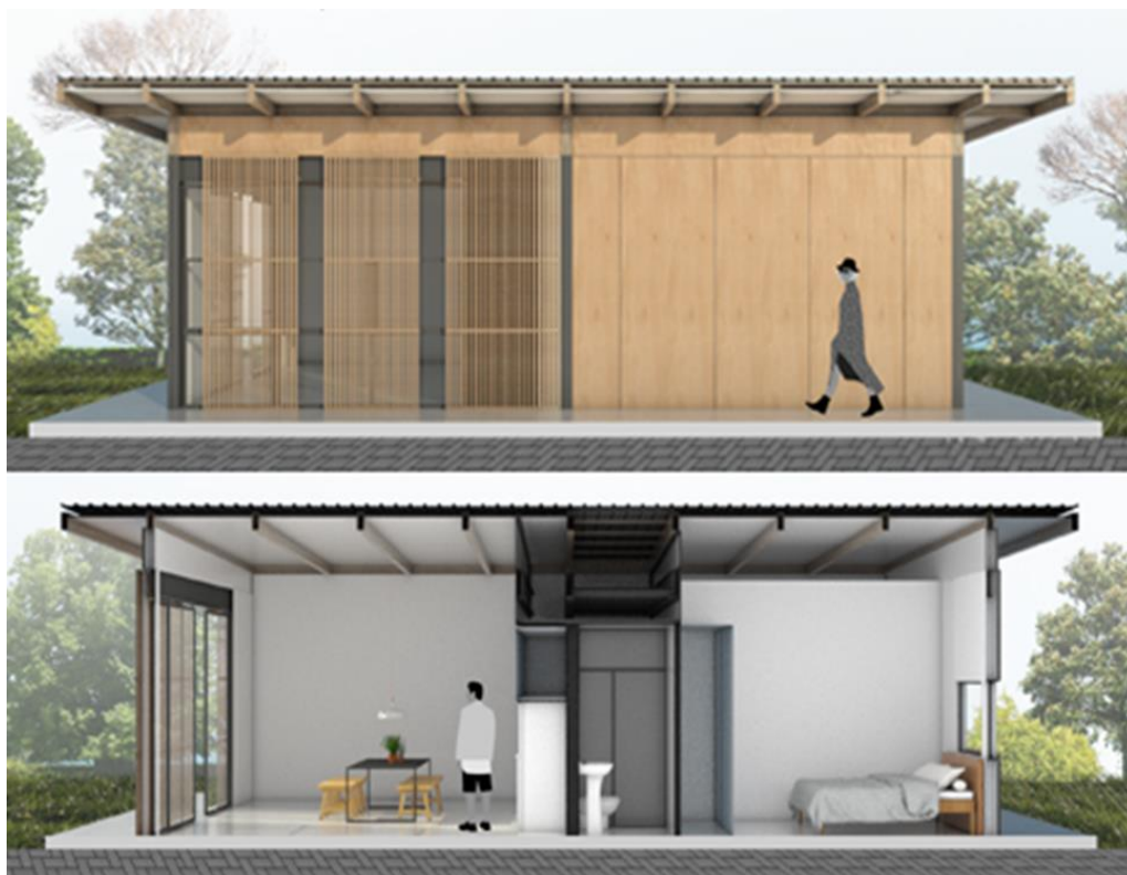
Figura 25 – Modelo para testes renderizado, com aplicação de materiais e organização interna
