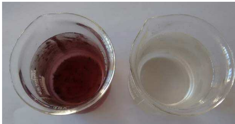
Figura 23 - Efluente têxtil secundário, à esquerda, e efluente têxtil secundário após 6 h de fotocatalise com HT/Fe/TiO 2 4:4, à direita.
