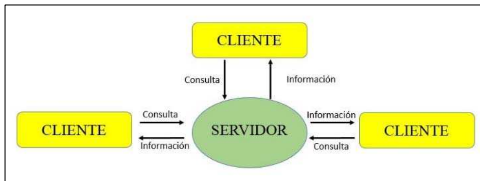
Figura 1: Esquema del concepto Cliente- Servidor.
