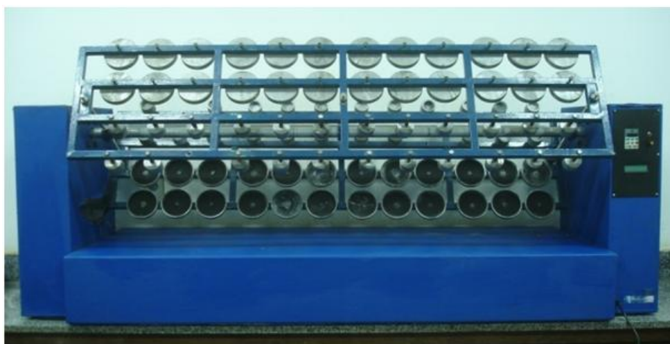
Figura 44: Dispersor mecânico utilizado para grandes volumes de solo.
