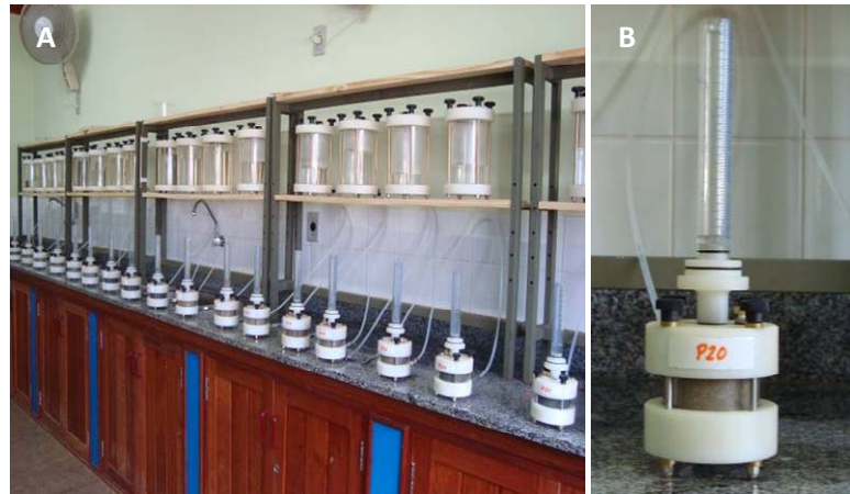
Figura 55: Sistema projetado e construído para a realização dos ensaios de permeabilidade: (A) vista parcial do conjunto de permeômetros; (B) detalhe da amostra com a proveta graduada em cm.
