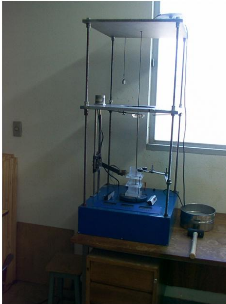
Figura 53: Empacotador de partículas construído para a produção de sistemas uniformes, binários e ternários.
