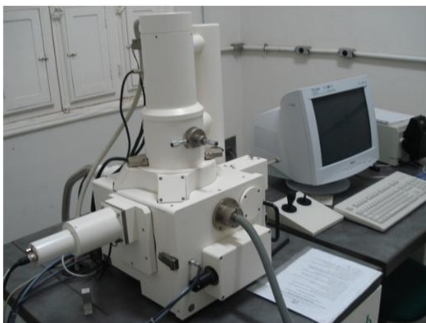
Figura 50: Microscópio eletrônico de varredura com câmera digital, modelo Leo 1430VP Zeiss, do Núcleo de Microscopia e Microanálise da UFV.
