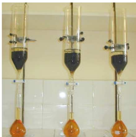
Figura 4 – Colunas contendo vermicomposto e respectivos frascos de coleta de eluato usados no experimento.
