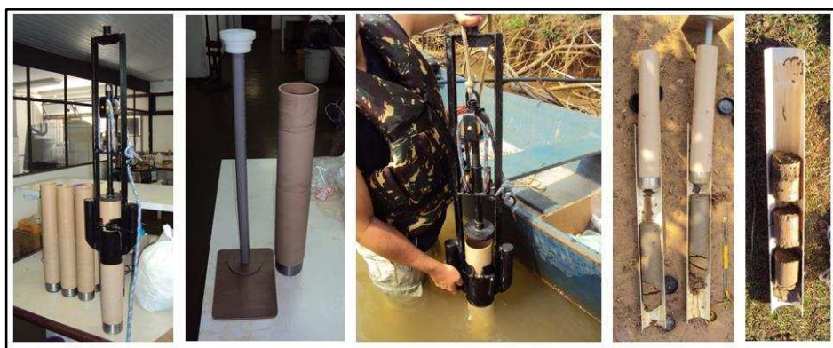
Figura 2. Representação do coletor de sedimento Ambuhl & Buhner (1975) com adaptação para o presente trabalho. Este coletor é bastante similar ao denominado Kajak-Brinkhurst citado por Mudrock & Macknight (1994).
