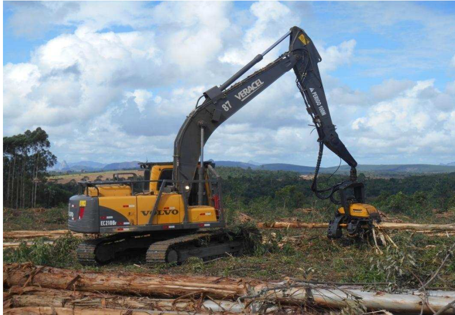
Figura 7 – Escavadeira hidráulica modelo EC 210BF prime da marca Volvo e cabeçote modelo H7 da marca Ponsse.
