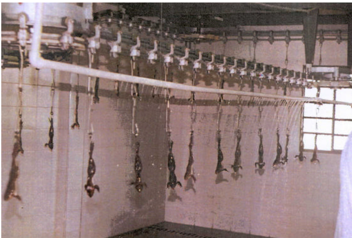
Figura 5 - "Nora" automática para transporte aéreo; equipamento comercial.
