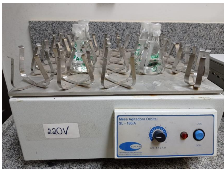
Figura 13. Mesa agitadora em que foi realizado o experimento de liberação in vitro do óleo essencial de P. cattleyanum do complexo de inclusão nos meios acetonitrila e solução aquosa de DMSO 1%.
