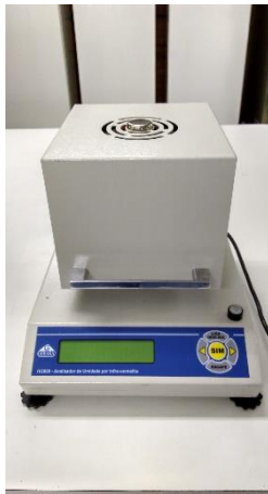
Figura 1 - Analisador de Umidade em: (A) vista; (B) vista do emissor de infravermelho
