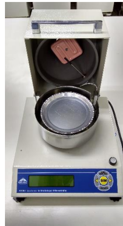
Figura 1 - Analisador de Umidade em: (A) vista; (B) vista do emissor de infravermelho
