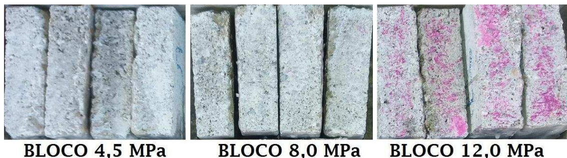
Figura 3.16 – Paredes dos blocos com fenolftaleína após 3 dias de carbonatação.
