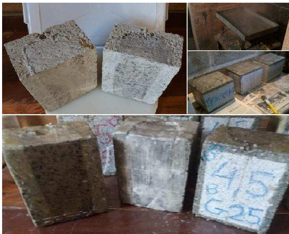
Figura 3.4 – Impermeabilização dos corpos de prova usando parafina nas 5 faces.
