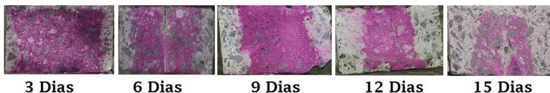
Figura 3.15 – Demonstração da frente de carbonatação para grautes de 25 MPa com uso de fenolftaleína.
