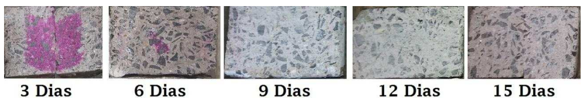
Figura 3.11 – Demonstração da frente de carbonatação para grautes de 15 MPa com uso de fenolftaleína.
