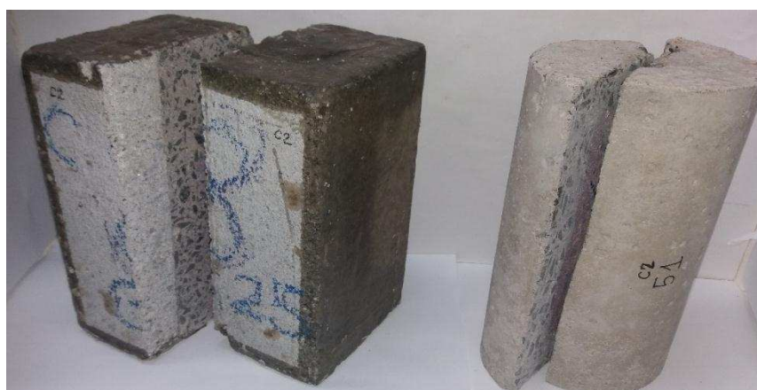
Figura 3.5 – Corte dos corpos de prova para medir frente de carbonatação.
