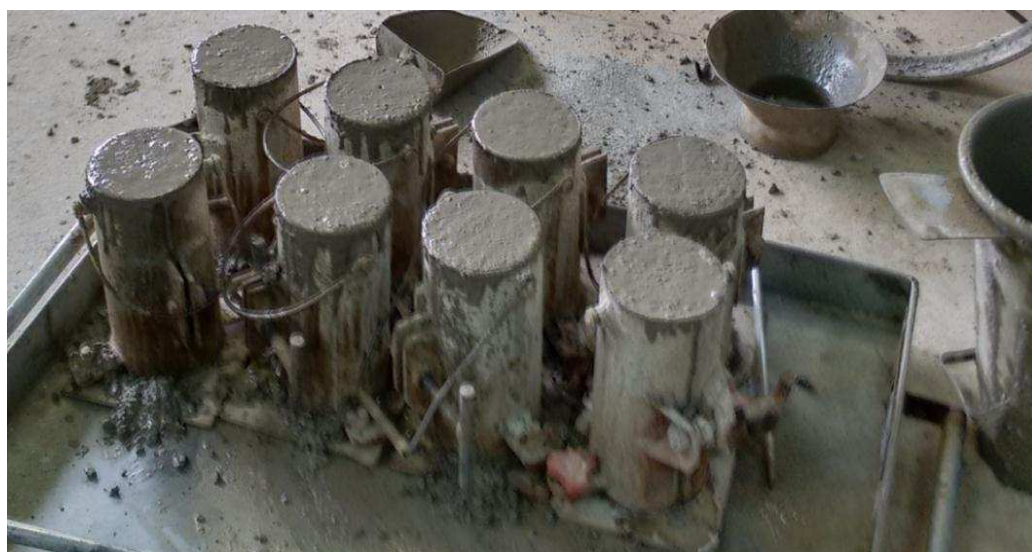
Figura 3.2 – Produção dos corpos de prova de graute para ensaios.
