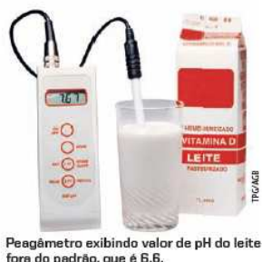
Figura 5 - Equipamento digital peagômetro
