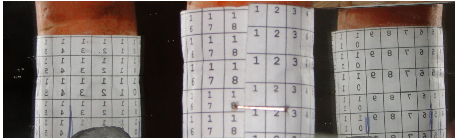
Figura 10. Imagens de uma raiz 3 cm de diâmetro. A imagem central foi capturada diretamente da raiz e as imagens à esquerda e à direita são reflexos do espelho.
