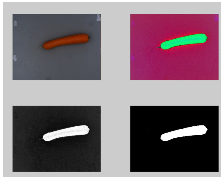
Figura 12. Etapas do processo da limiarização das imagens. (a) Imagem RGB. (b) imagem HSV (c) Imagem da banda S e (d) Imagem limiarizada
