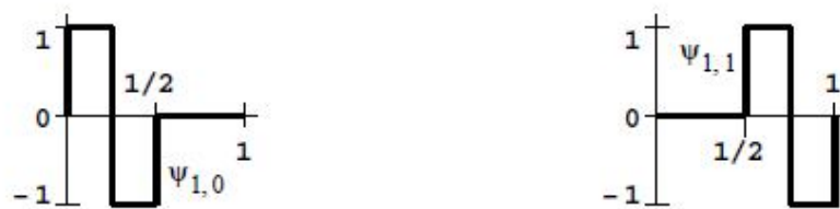
Figura 5. Gráfico das funções de Haar original \psi_{1,0}(t) (a) e deslocada no eixo t , \psi_{1,1}(t) (b)
