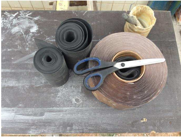
Figura 47 – Manta EPDM cortada juntamente com a fita de caldeação e adesivo.
