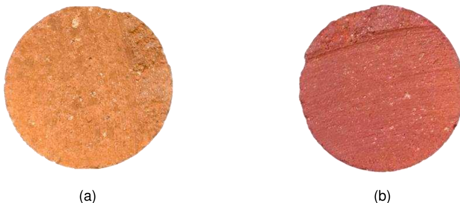
Figura 3.16: Corpos de prova moldados nos padrões para o ensaio de RCS submetidos à aspersão com fenolftaleína: cura carbonatada (a); cura úmida (b).
