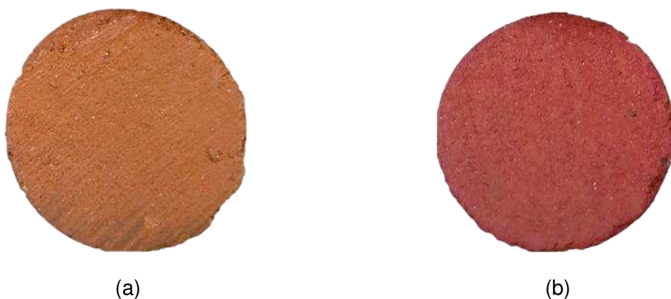
Figura 3.17: Corpos de prova moldados nos padrões para o ensaio de mini-CBR submetidos à aspersão com fenolftaleína: cura carbonatada (a); cura úmida (b).
