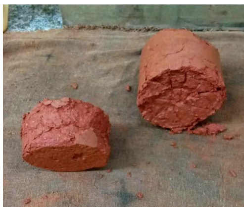
Figura 3.11: Corpo de prova carbonatado no 4º ciclo de molhagem e secagem.
