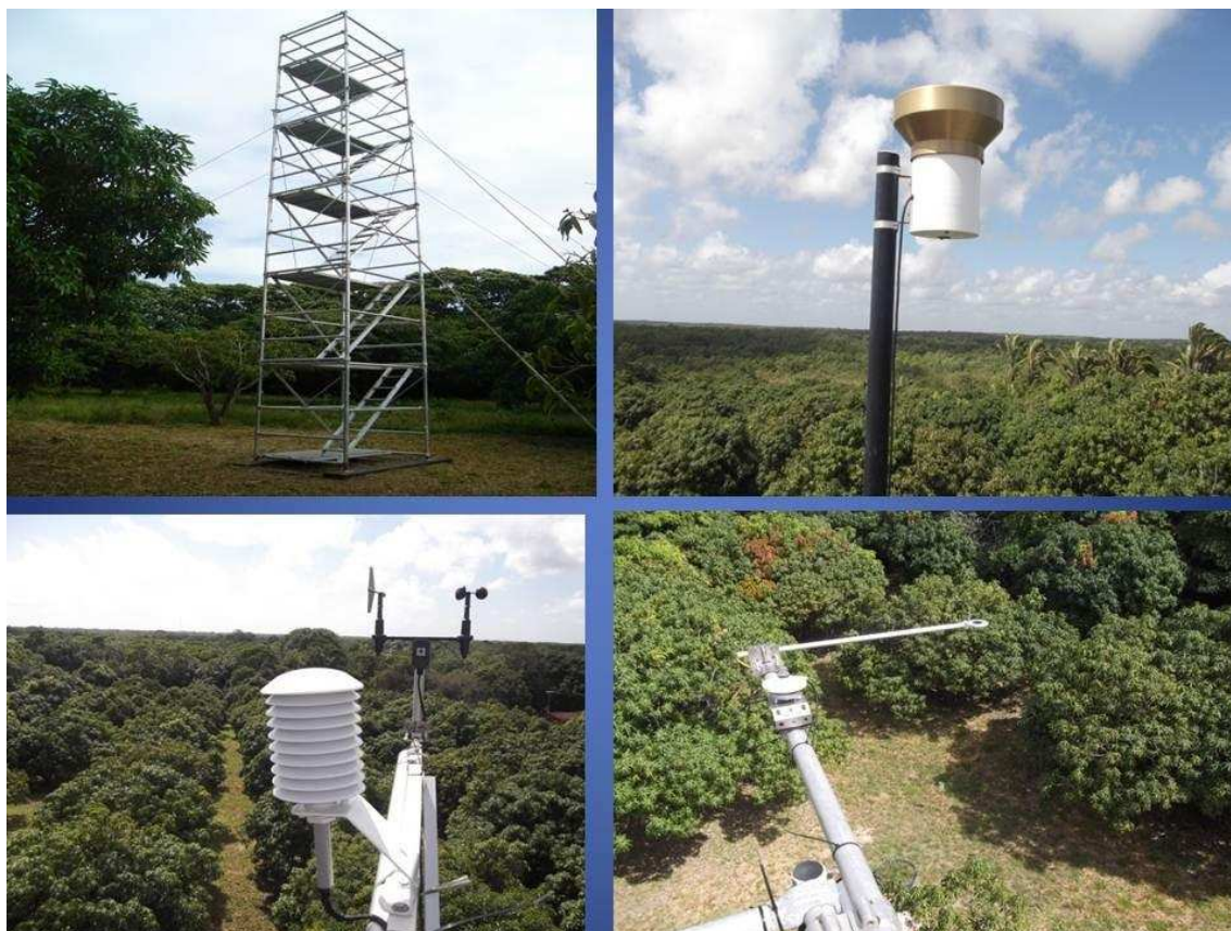
Figura 6- Torre micrometeorológica e equipamentos.
