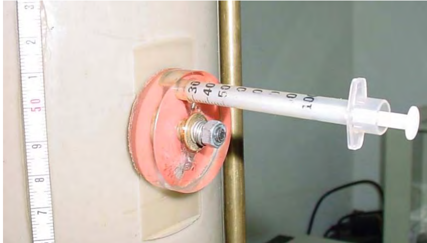
Figura 3.14 – Detalhe da régua de medição e do furo para retirada de amostra.
