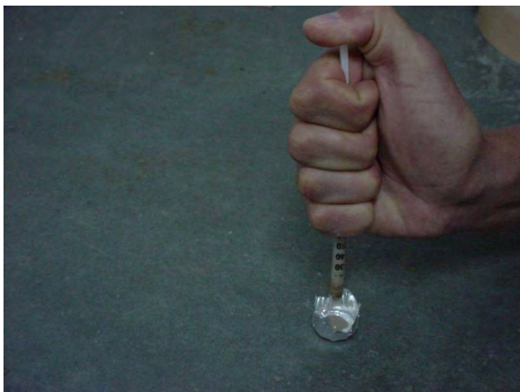
Figura 3.21 – Colocação de amostra de rejeito para determinação do teor de umidade.
