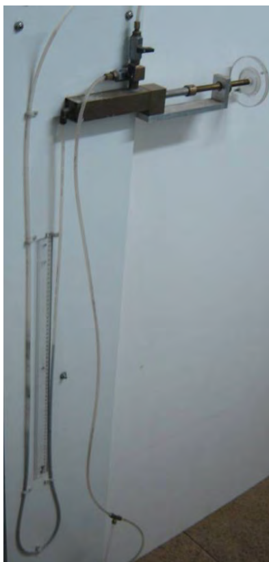
Figura 3.12 – Sistema de aplicação de pressão utilizado na calibração dos transdutores.
