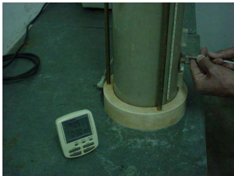
Figura 3.20 – Extração de amostra de rejeito durante ensaio de sedimentação.
