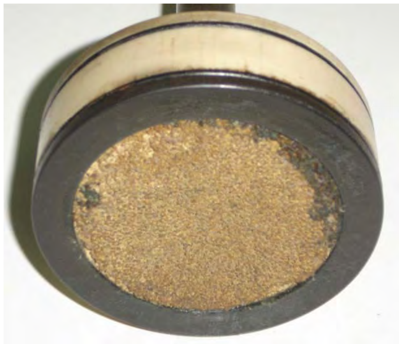
Figura 3.7 – Foto mostrando pedra porosa instalada no top cap .
