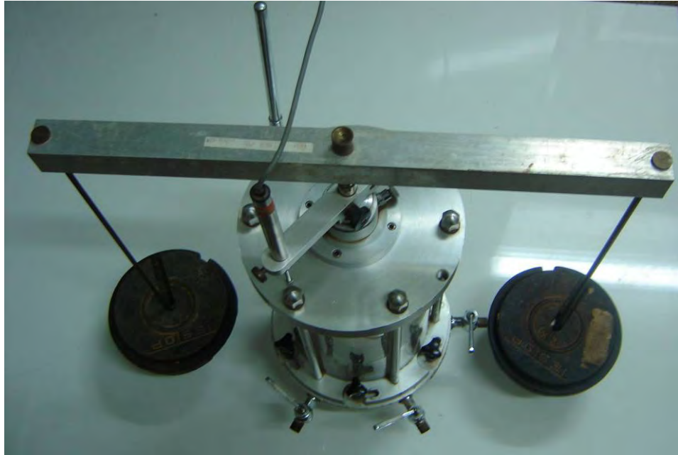
Figura 3.8 – Foto mostrando o sistema de carregamento.
