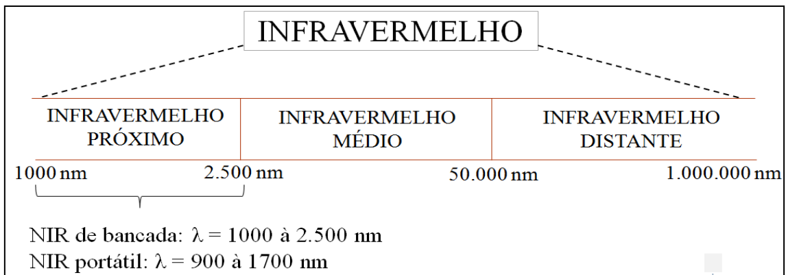
Figura 1 – Esquema resumido sobre os tipos de infravermelho. O comprimento de onda apresentado corresponde aos instrumentos usados nessa pesquisa. FONTE: Adaptado de Pasquini (2003).
