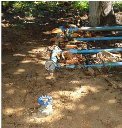
Figura 4 - Sistemas de válvulas para controle das lâminas de irrigação nos dois ciclos de cultivos. Guanambi, BA, 2012 e 2013.
