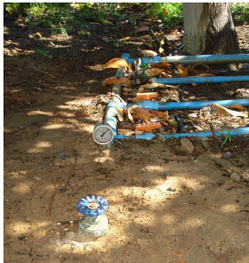
Figura 3 - Sistemas de válvulas para controle das lâminas de irrigação nos dois ciclos de cultivos, Guanambi, 2012 e 2013.
