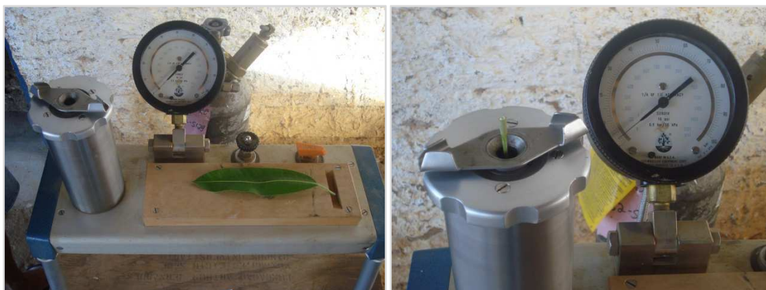
Figura 9 - Avaliação do potencial hídrico da folha de mangueira ‘Tommy Atkins’, utilizando câmara de Scholander. Guanambi, BA, 2013.
