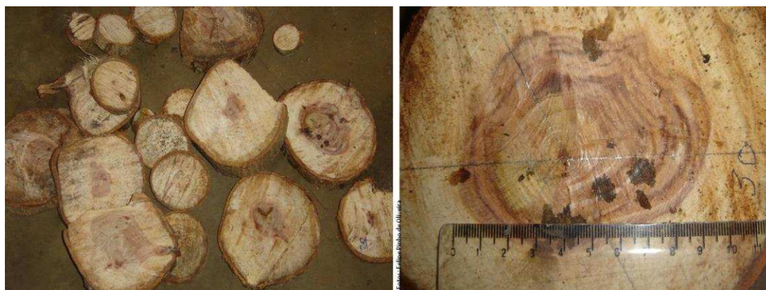
Figura 5. Discos de madeira coletados na cubagem rigorosa e utilizados nos cálculos de densidade de madeira e poder calorífico.
