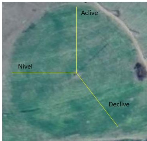
Figura 2 - Imagem do pivô central com seus respectivos raios, aclave, declive e nível
