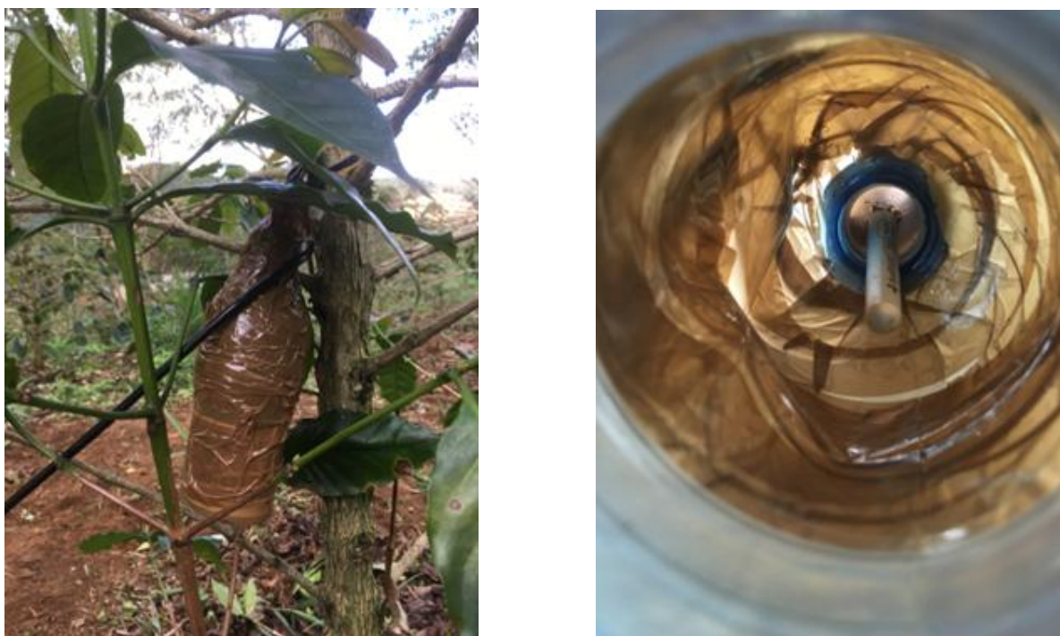
Figura 9: Instalação dos termômetros para monitoramento da temperatura do ar
