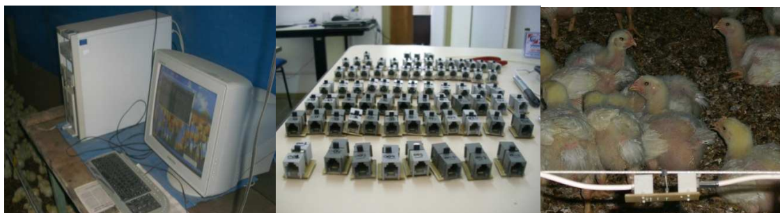
Figura 2 - Computador e sensores de temperatura do ar conectados entre si por uma rede de transmissão de dados com a tecnologia 1-Wire™.
