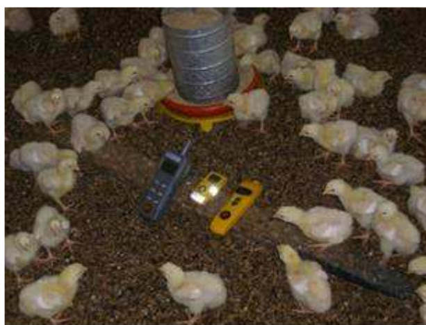
Figura 6 - Medição das concentrações de NH 3 , CO 2 e CO ao nível do pintinho.
