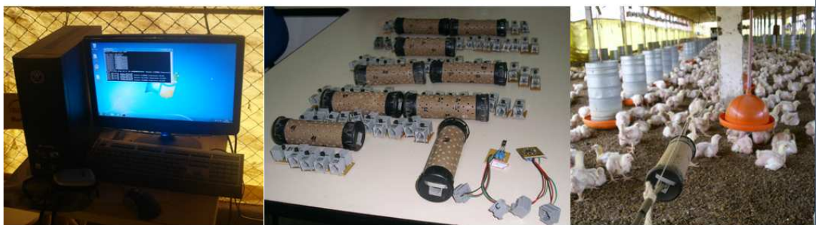
Figura 5 - Computador e sensores de umidade relativa e temperatura do ar conectados entre si por uma rede de transmissão de dados 1-Wire TM .
