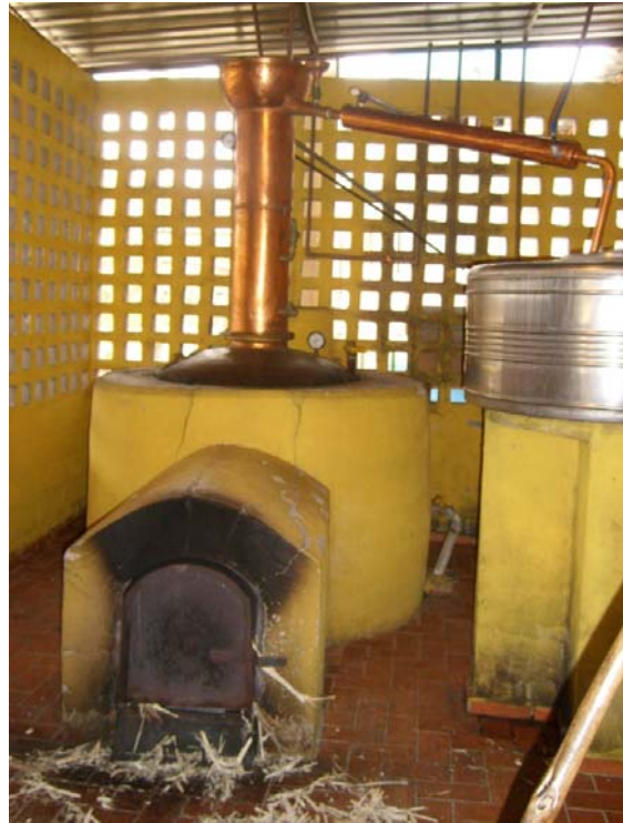
Figura 21 – Alambique de cobre utilizado para a destilação da aguardente.
