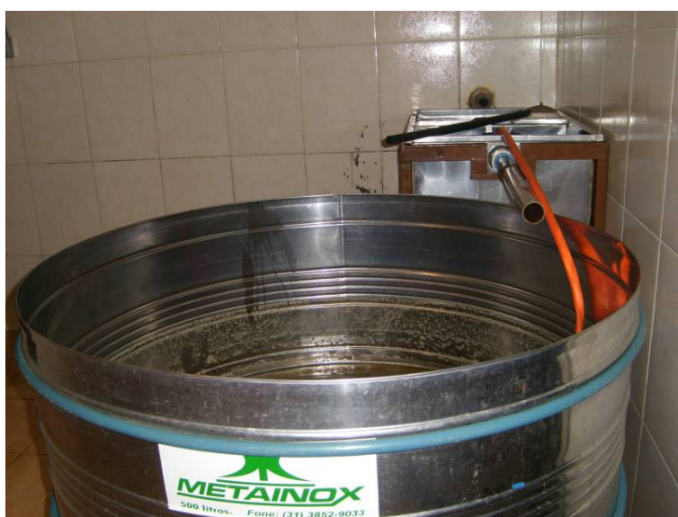
Figura 18 – Sistema de decantação e diluição do caldo para ajuste do teor de açúcar.
