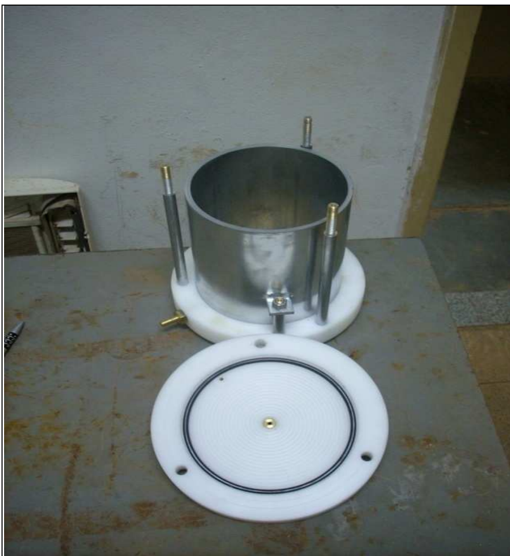
Figura 19 – Cilindro preparado para os ensaios de permeabilidade e resistência a compressão
