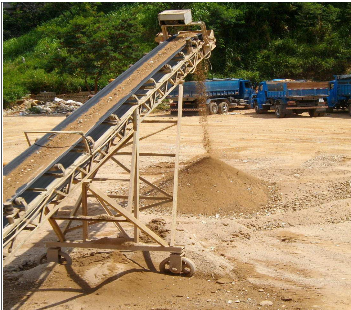
Figura 13 – Esteira conduzindo o material britado
