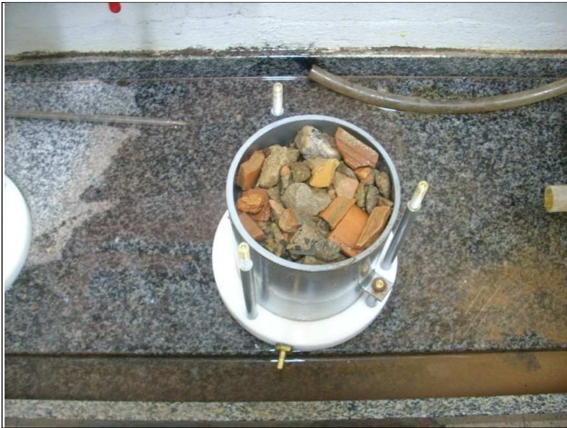
Figura 20 – Preparo da amostra no permeâmetro
