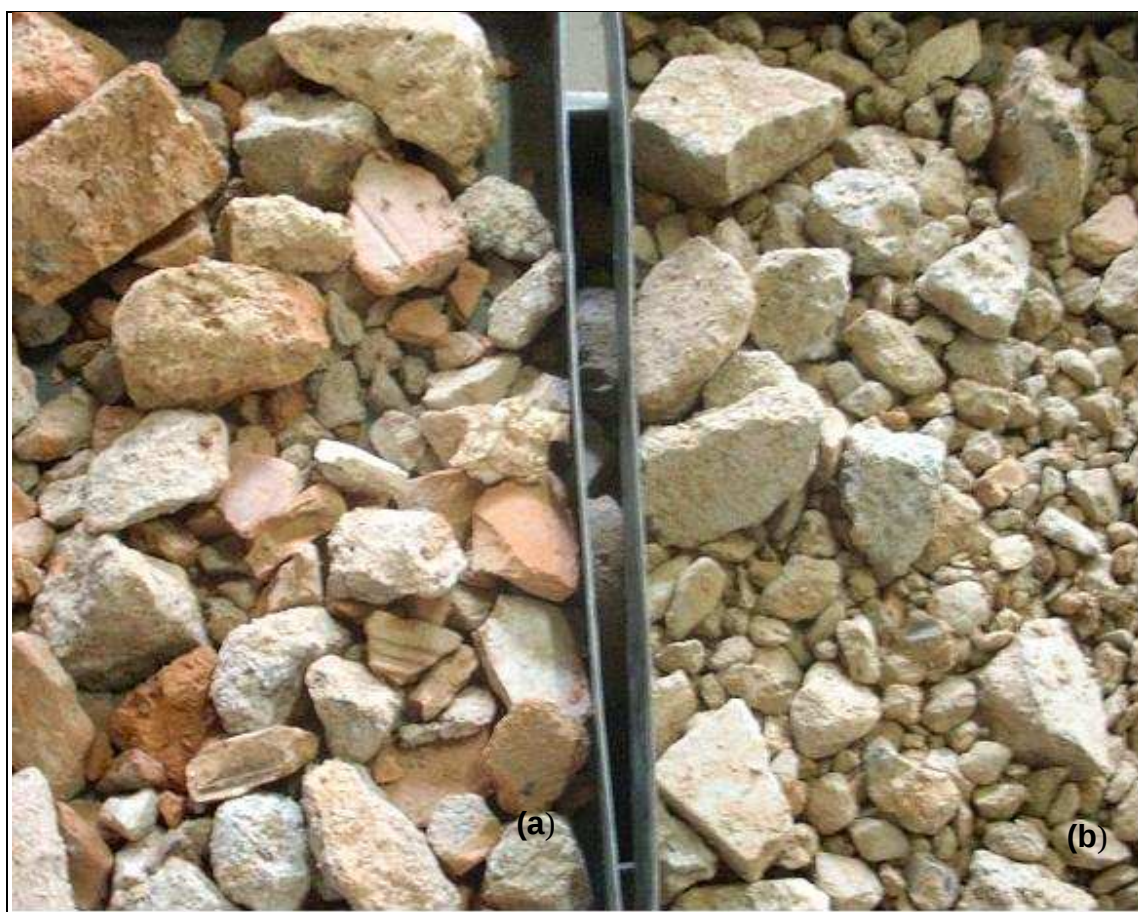
Figura 3 – Separação dos RCD por tipo: (a) Tipo II; (b) Tipo I.
