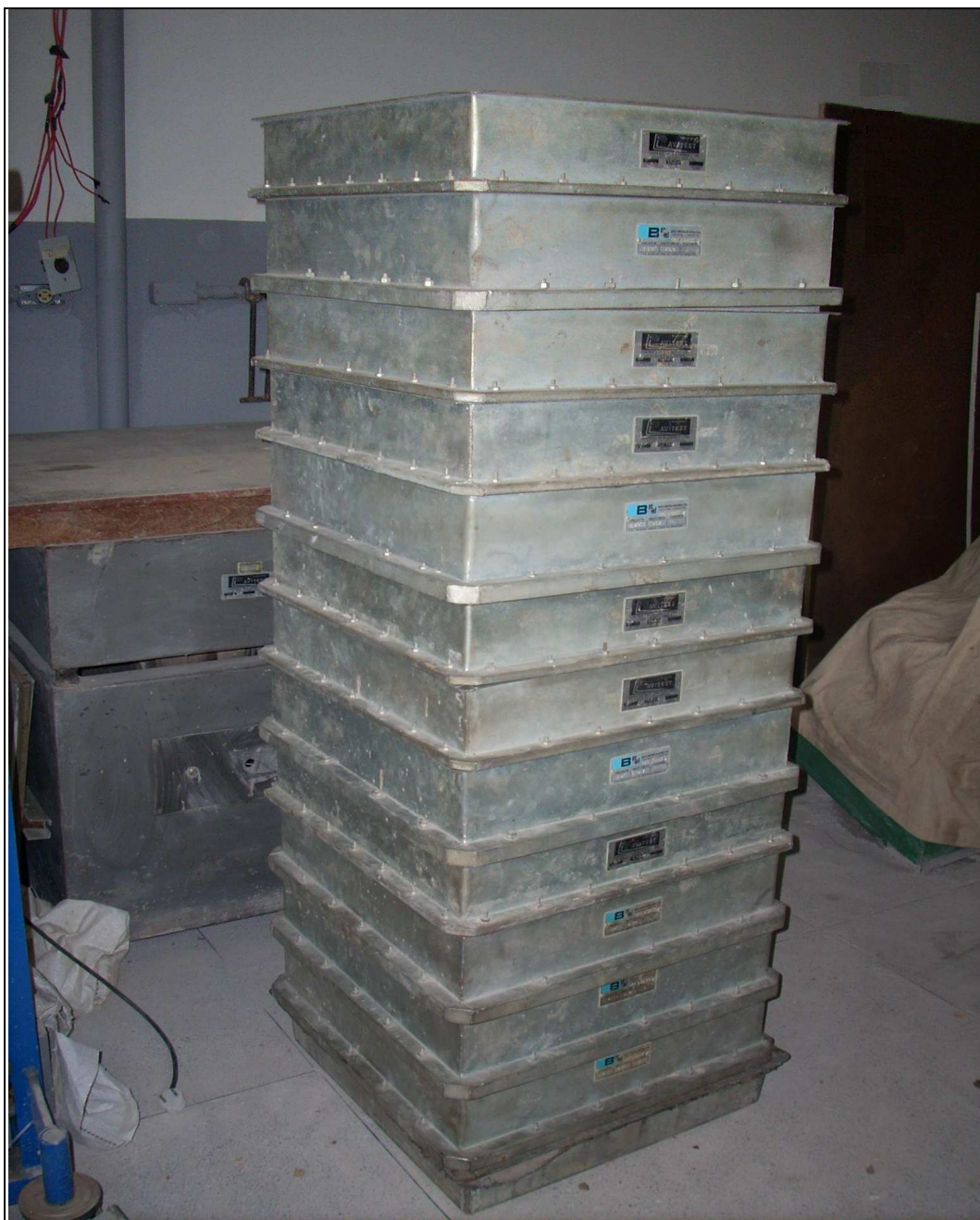
Figura 18 – Jogo de peneiras utilizado nos ensaios
