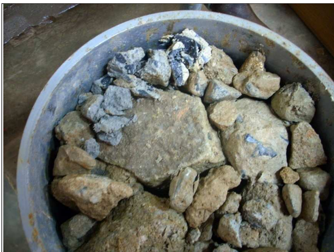
Figura 43 – Amostra após o ensaio de compressão
