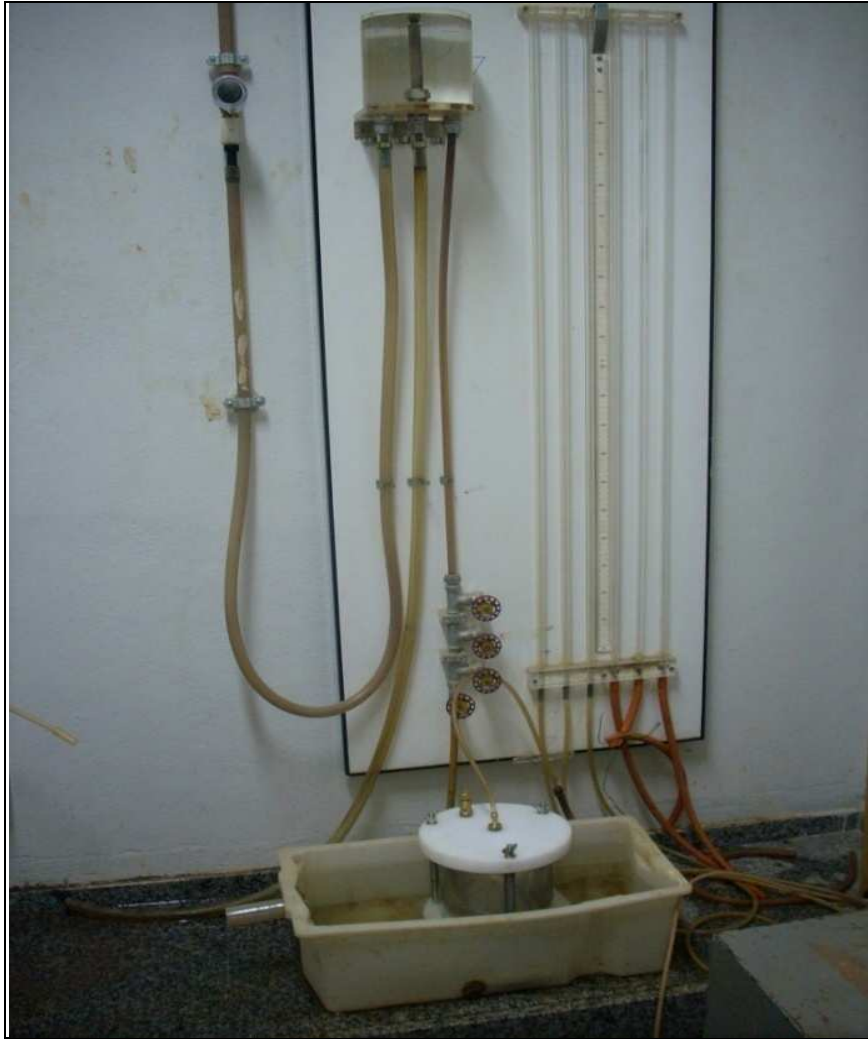
Figura 21 – Realização do ensaio de permeabilidade com carga constante
