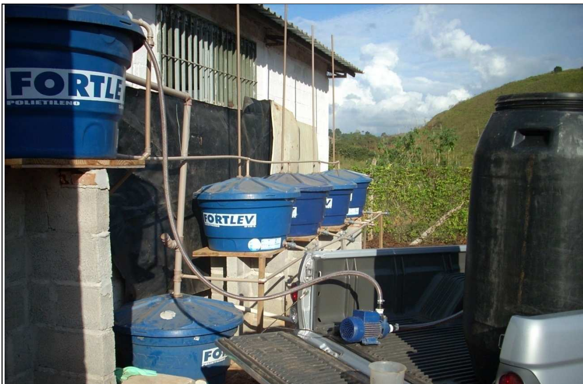
Figura 28 – Abastecimento do reservatório superior com lixiviado
