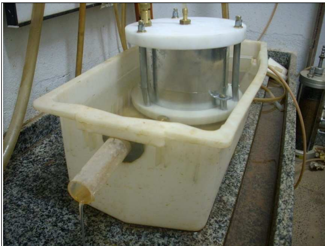
Figura 22 – Detalhe do controle de percolação de água na amostra
