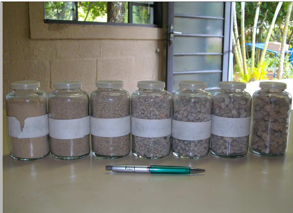
Figura 5 – Algumas das distribuições granulométricas que podem ser obtidas com o ajuste do britador da Usina de Reciclagem de Estoril
