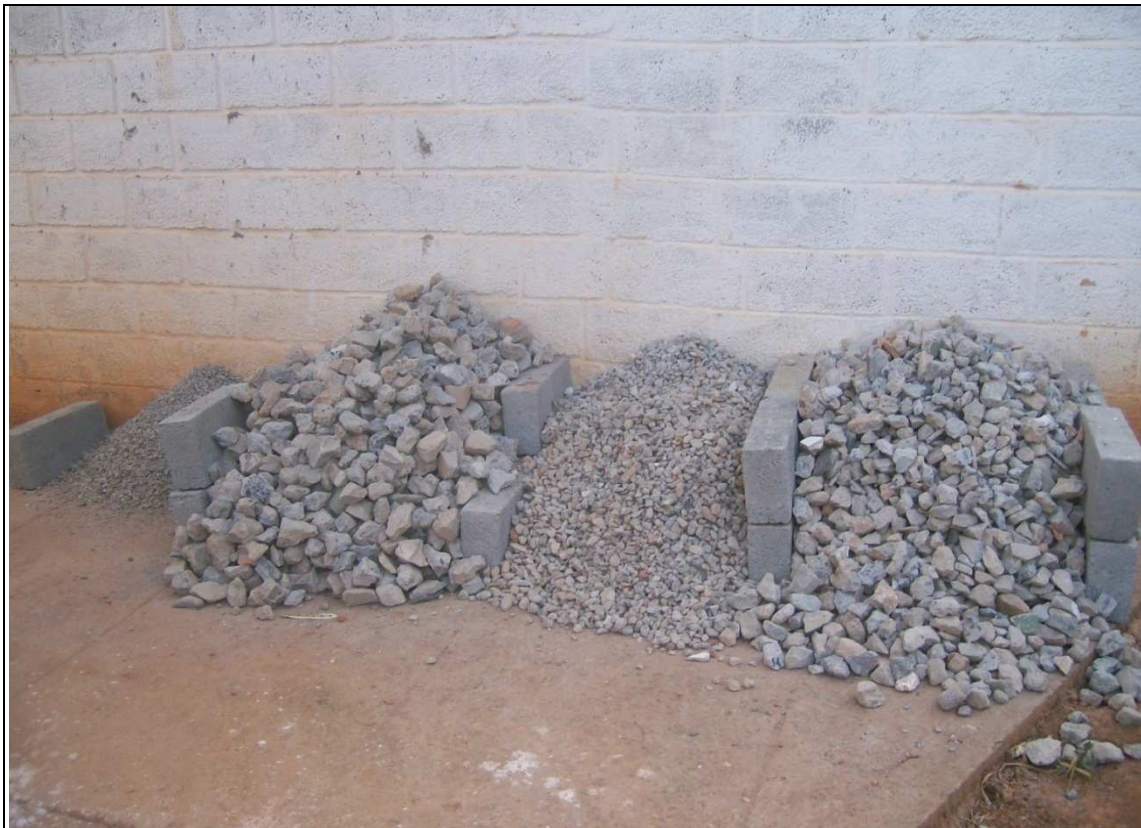
Figura 15 – Estocagem do material tipo cinza de acordo com a distribuição granulométrica
