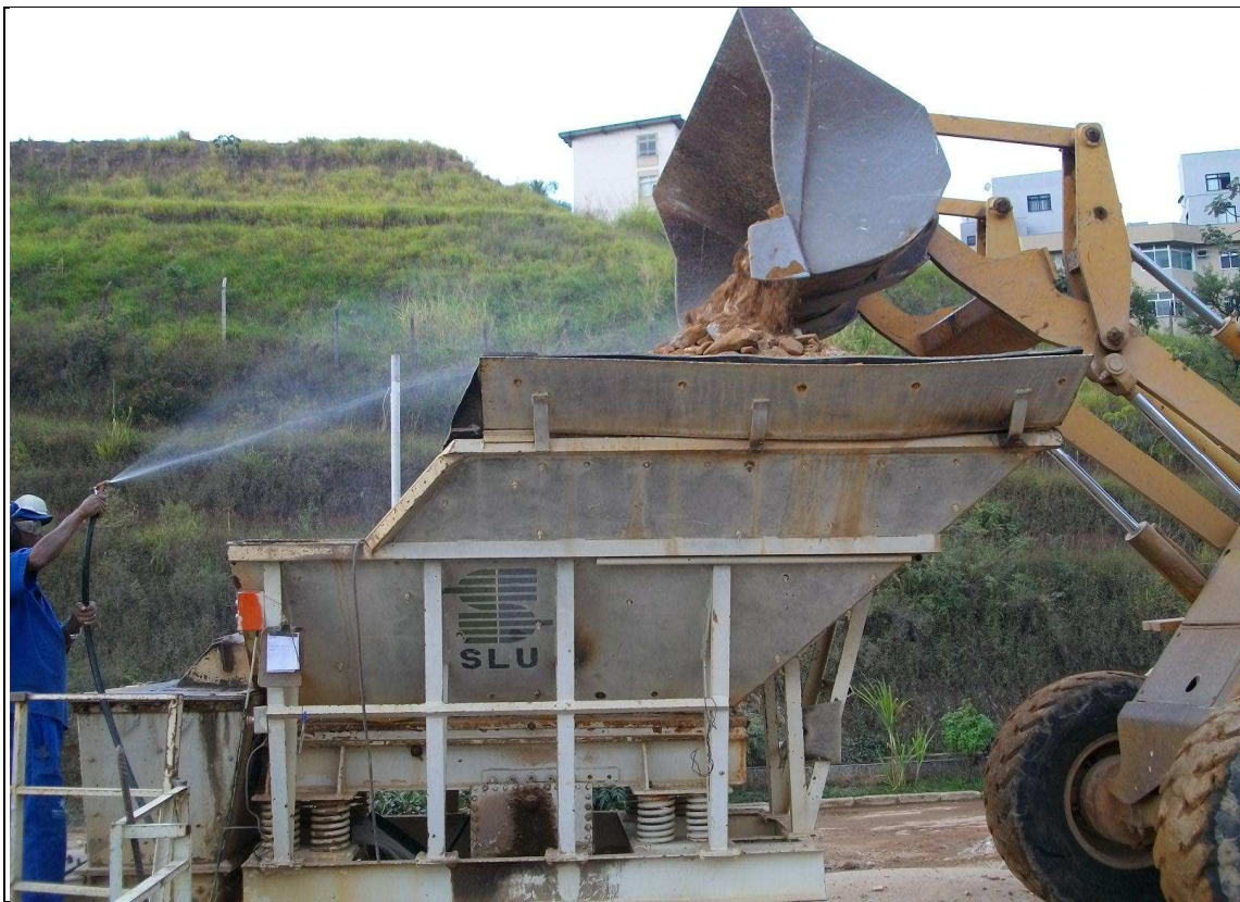
Figura 11 – Carregamento do britador
