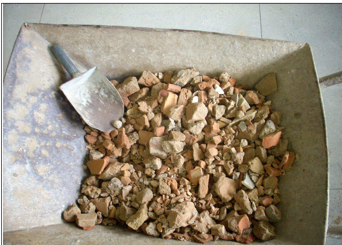
Figura 17 – Amostra preparada para realização do ensaio de granulometria
