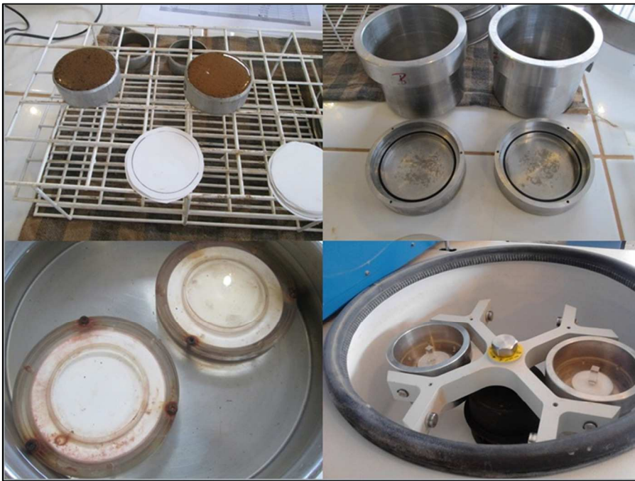
Figura 3.6: Equipamentos usados na centrífuga e posição dos mesmos na centrífuga.
