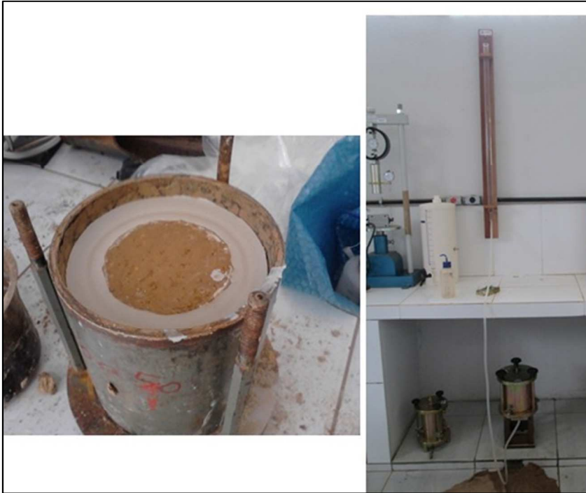
Figura 3.2: (a) Configuração do Ensaio no Permeâmetro; (b) Ensaio em funcionamento.
