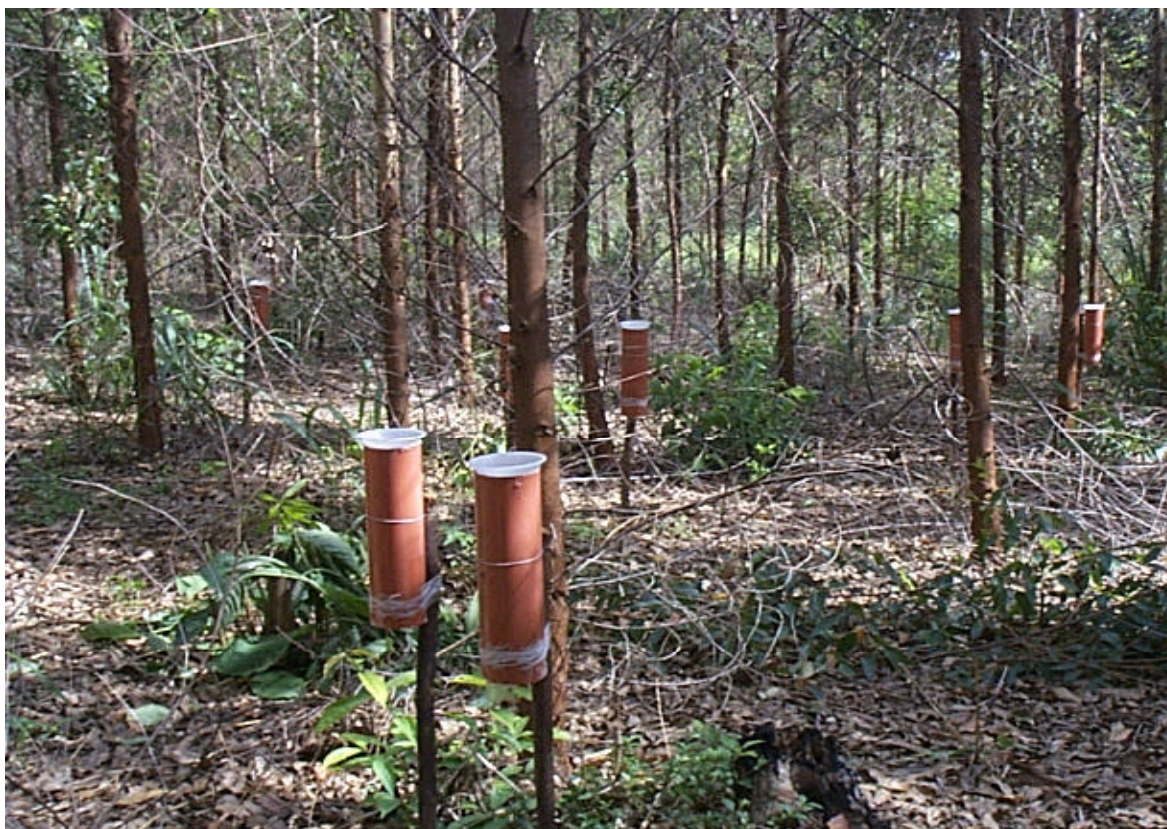
Figura 03. Vista dos coletores de precipitação interna ( T_r ) no plantio de 2 anos de idade.
