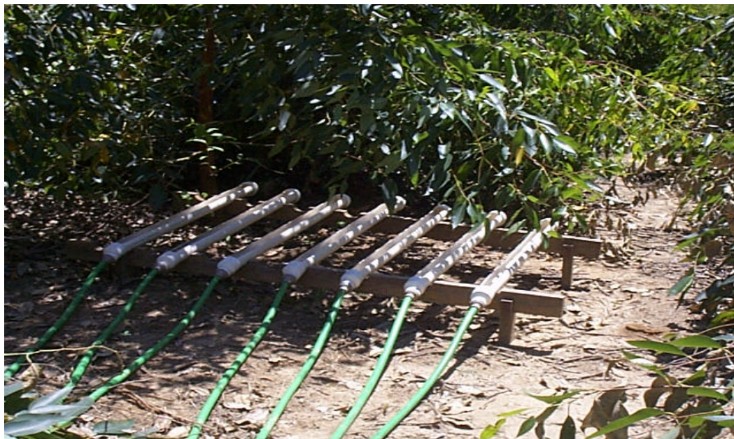
Figura 04. Vista dos coletores de precipitação interna ( T_r ) no plantio de 1 ano de idade.
