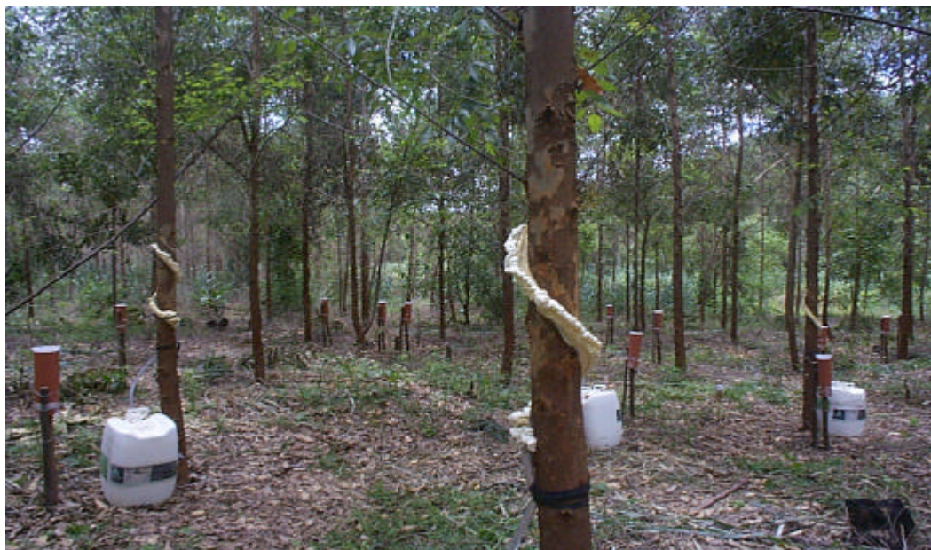
Figura 05. Vista dos coletores de água da chuva escoada pelos troncos ( S_t ) e de precipitação interna ( T_r ) no plantio de 2 anos de idade.
