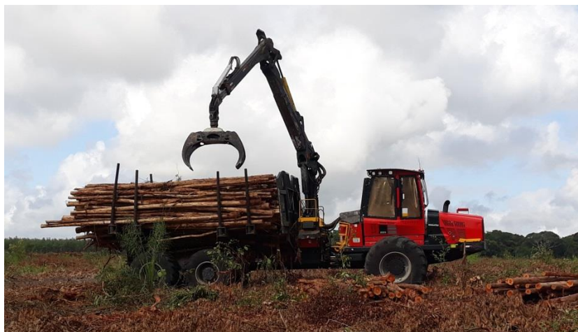
Figura 1. Forwarder da marca Komatsu, modelo 895.
