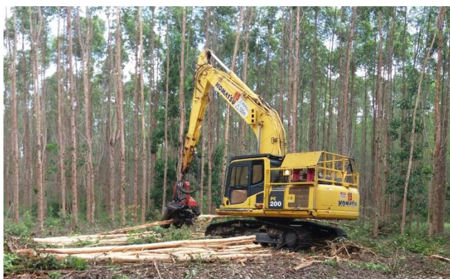
Figura 1. Harvester da marca Komatsu , modelo PC200 e cabeçote da marca Komatsu , modelo 370E.
