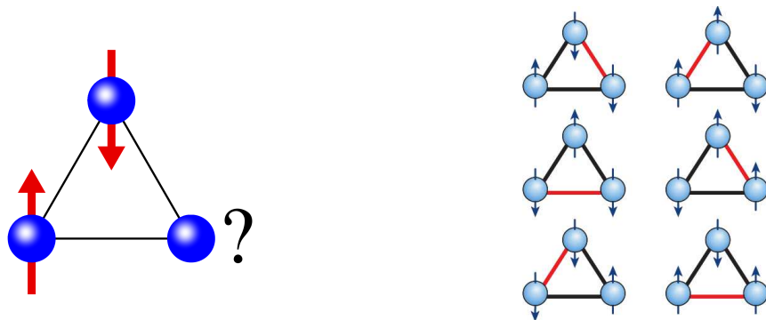
Figura 1.4: Exemplo de uma rede frustrada. Na esquerda, a impossibilidade dos três spins se alinhem antiparalelamente entre si e na direita os vários estados degenerados da rede triangular.
