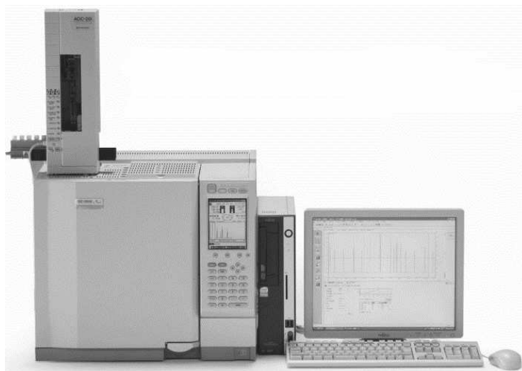
Figura 10: Cromatógrafo a gás GC-2010 Plus da Shimadzu.
