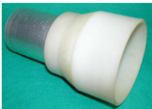
Figura 17: Funil redutor para aumentar a resistência ao fluxo de ingesta no viscosímetro de tubo em um modelo ex vivo de compactação.
