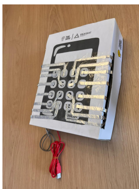
Figura 5.6: Calculadora: Frente com ligações em alumínio - Fonte: Próprio autor
