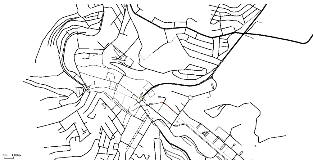
Figura A1 – Interface do SUMO - Resultado da Conversão com NETCONVERT da Parte Central de Viçosa Fonte: Autoria própria
