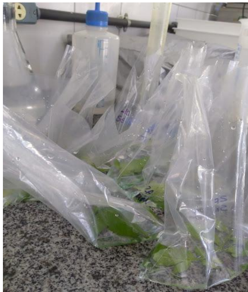
Figura 18- Procedimento de lavagem dos folíolos com água destilada para extração do traçador azul brilhante
