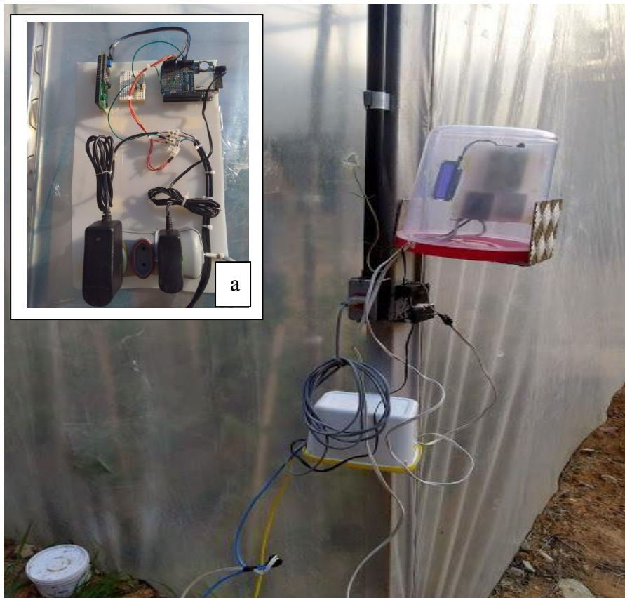
Figura 24 - Sistema de automação da nebulização (a) Sistema de controle no qual foi empregado para monitorar os tratamentos e o tempo de aplicação
