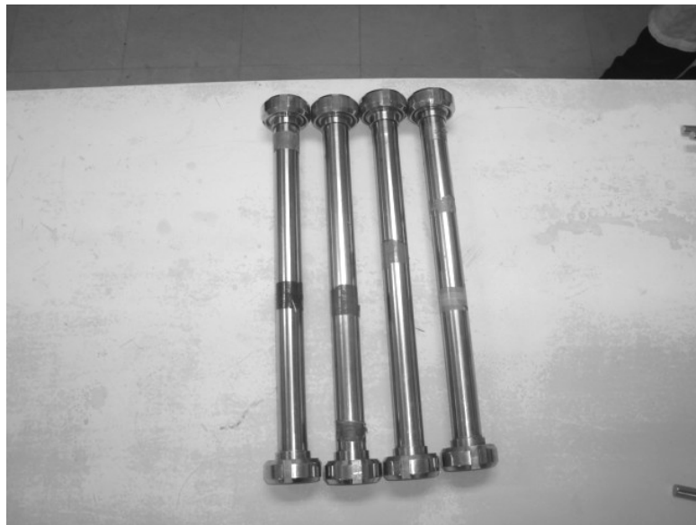
Figura 1 – Tubos de prova de aço inoxidável AISI 304 polimento nº 4, com 33 cm de comprimento e diâmetro 3,1 cm e extremidades fechadas com tampas rosqueáveis.
